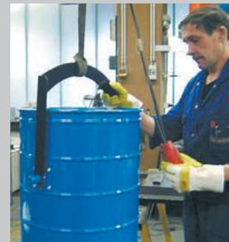
Der Sammelbehälter kann mit einem Transport- und Entleerungsbügel ausgerüstet werden, mit dem der Sammelbehälter mit Hilfe eines Krans oder Gabelstaplers angehoben werden kann.
