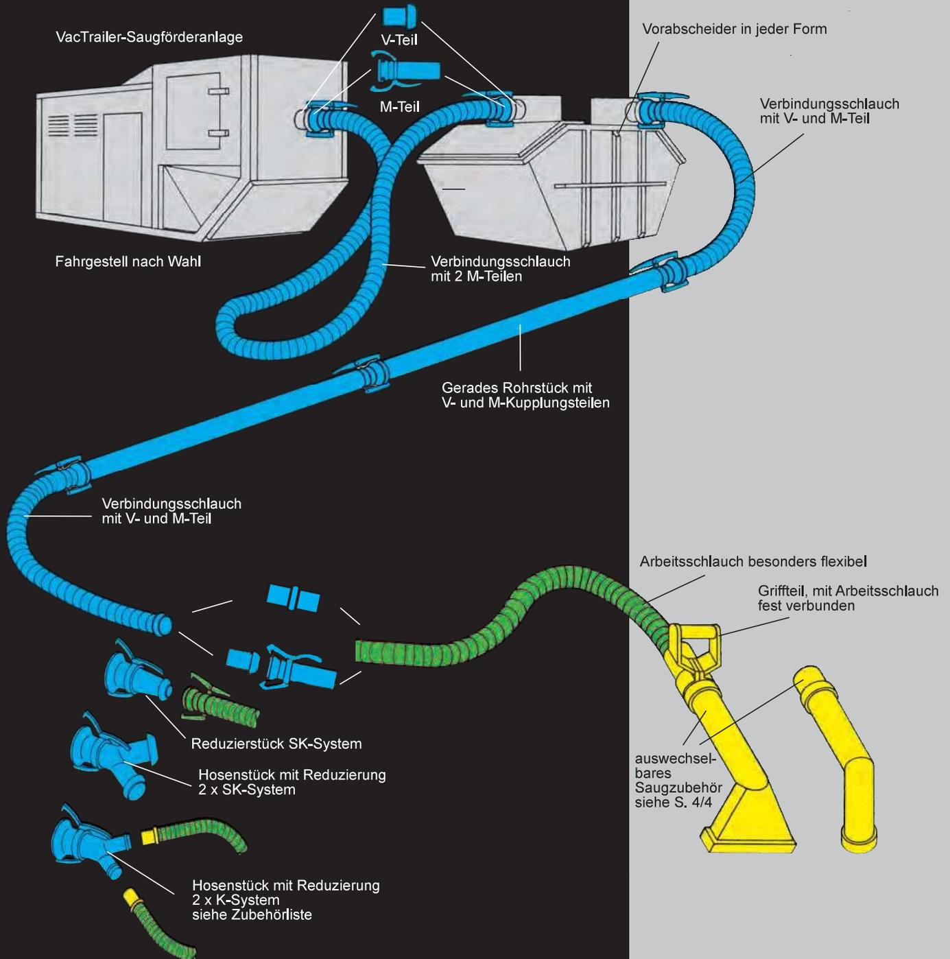
Arbeitsschläuche werden nur auf der einen Seite mit einem Kupplungsteil ausgerüstet. Die Seite ohne Kupplungsteil wird mit dem Spanning zum Abschluss der Handsaugrohre und Bodendüse verwendet.
