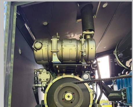
Wassergekühlter, dauerbetriebsfester Kubota-Dieselmotor, Turbolader, 55,4 kW
