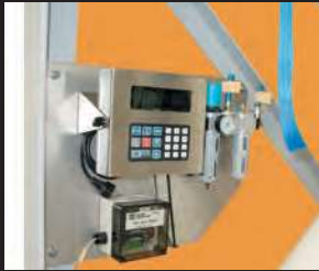
Wiegevorrichtung überwacht Füllgewicht
