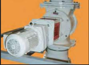
Zellenradschleuse entleert Sammelbehälter kontinuierlich
