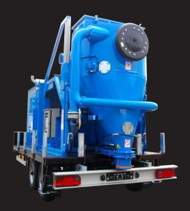
VacTrailer S-6, die kompakte Großleistungs-Sauganlage zum Saugen und Fördern von trockenen Schüttgütern und explosiven Stäuben.
