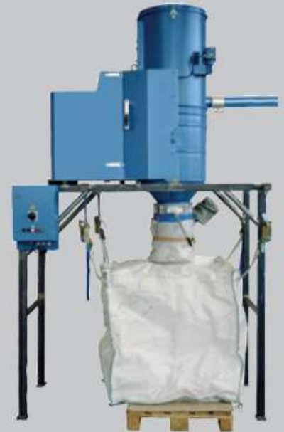
Entleerung in BigBags. Das Sauggut wird transportbereit der Anlage entnommen.
