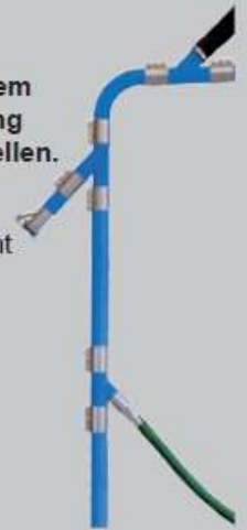
Entleerung in BigBags. Das Sauggut wird transportbereit der Anlage entnommen.
