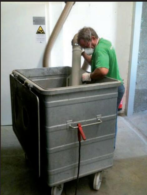
Asche wird aus einem Reststoffsammelbehälter gesaugt
