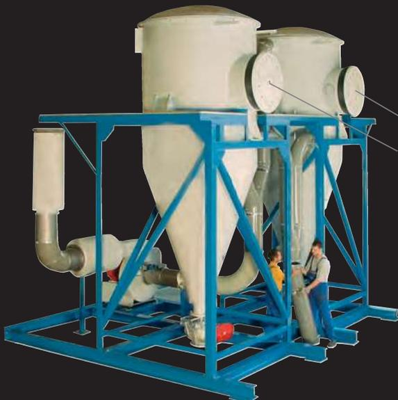
Absaugen von aufsteigendem Kohlestaub beim Befüllen von Kohlebunkern
