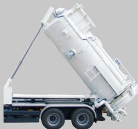
Hydraulisch betätigte Kippentleerung, Kippwinkel 60°
